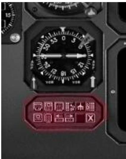
I tre pannelli secondari dipendenti da questo Controller si attivano e disattivano coi pulsanti **primo**, **secondo** e **quinto** da sinistra della fila superiore. Si tratta, nell'ordine, della **Center Console**, del **Flight Management System** (FMS o FMC o MCDU) e del **Pedestal**.
